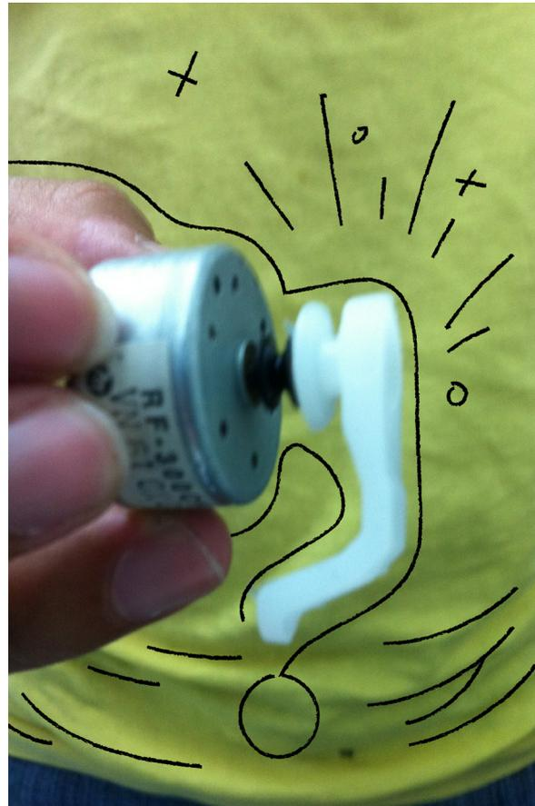
La pieza negra que sale del motor es el vástago. Cuida de no llenar de silicón los huecos del motor pues lo paralizarías.
